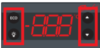
Obr. 5. Ovládací prvky regulátoru Danfoss ERC 112.
