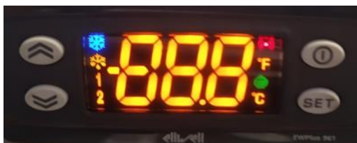
Obr. Indikační a ovládací prvky ovladače Eliwell .
